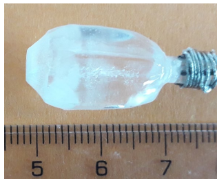
Figura 2. Cristal LYSB crescut de-a lungul axei c din compoziția topiturii inițiale
